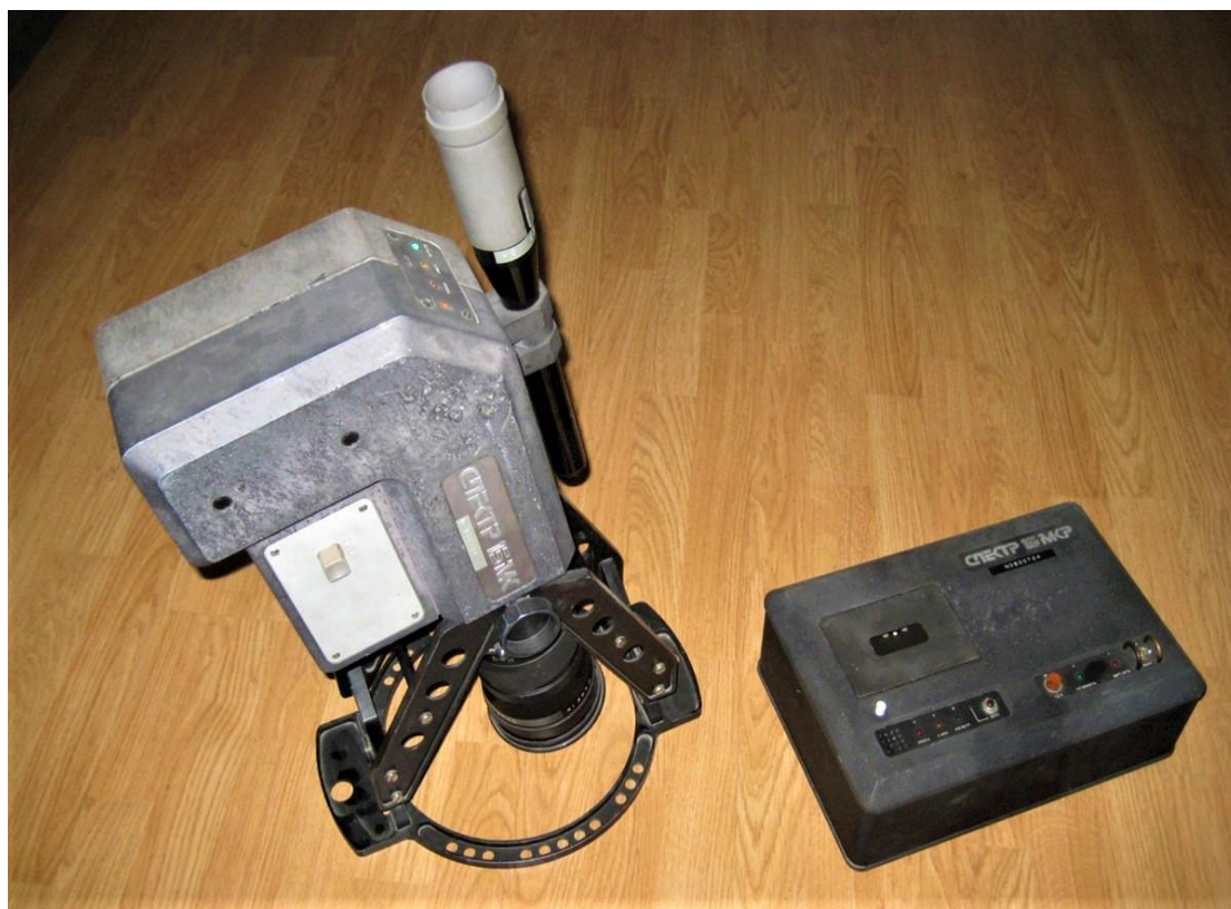
Спектрометричната система „Спектър-15“, разработена по програмата за полета на първия български космонавт
