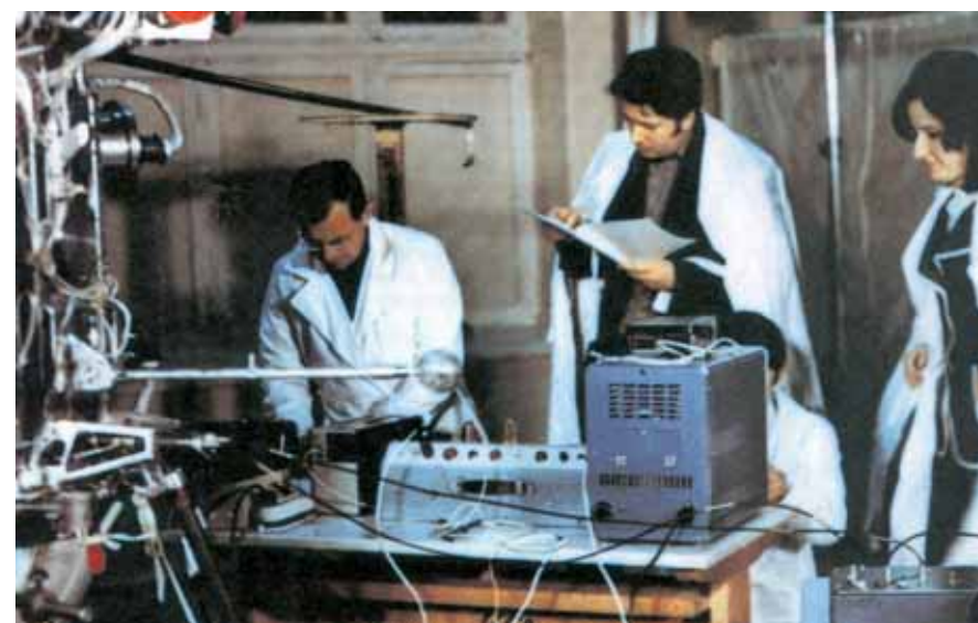
Фиг. 3 Предстартови изпитания на прибор П-1 монтиран на спътника „Интеркосмос-8“ в Монтажно-изпитателния корпус на космодрума Плесецк, Архангелска област
