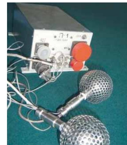
Фиг. 1 Първият български сондов прибор П-1 с датчиците СЙУ за директно измерване на параметрите на йоносферната плазма от борда на спътника „Интеркосмос-8“.
